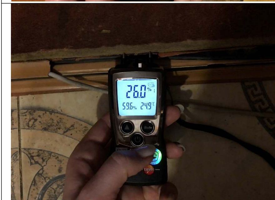
Фото №17. Измерение уровня влажности в деревянном пороге в коридоре.
